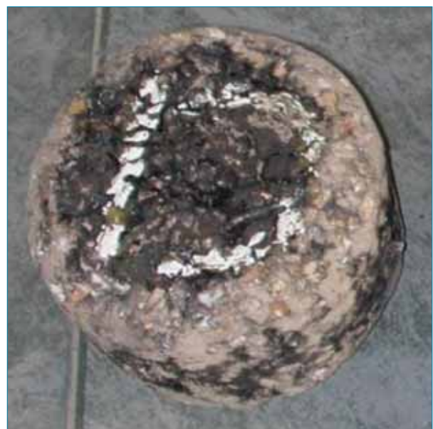
Probeta de mezcla porosa tras el ensayo de pérdida de partículas.
