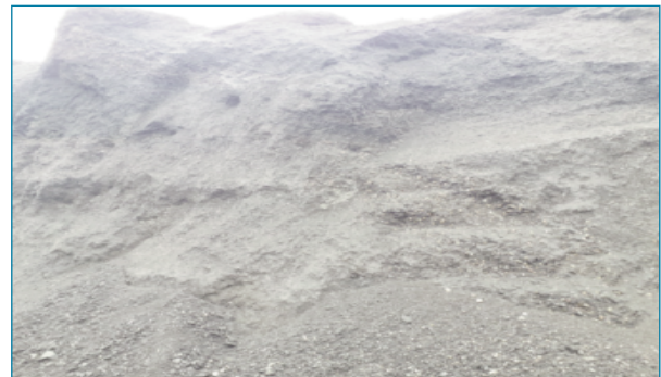
Ilustración 1. Acopio de asfalto retirado en planta
