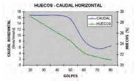
Figura 6: Gráfico de huecos y caudal horizontal con las diferentes energías aplicadas.
