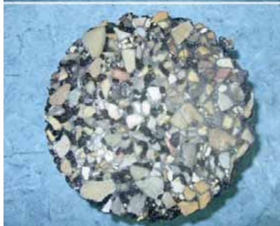
Fotos 7 y 8: Mezcla porosa árido grueso 70 % cúbico + 30 % lajo.
