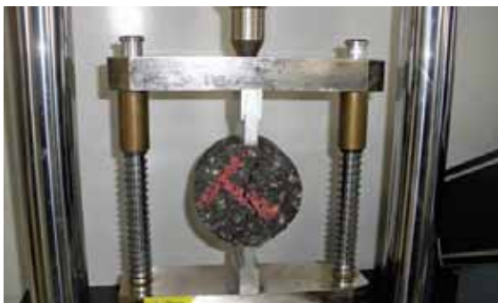
Figura 1. Rotura de probeta en el ensayo de sensibilidad al agua
