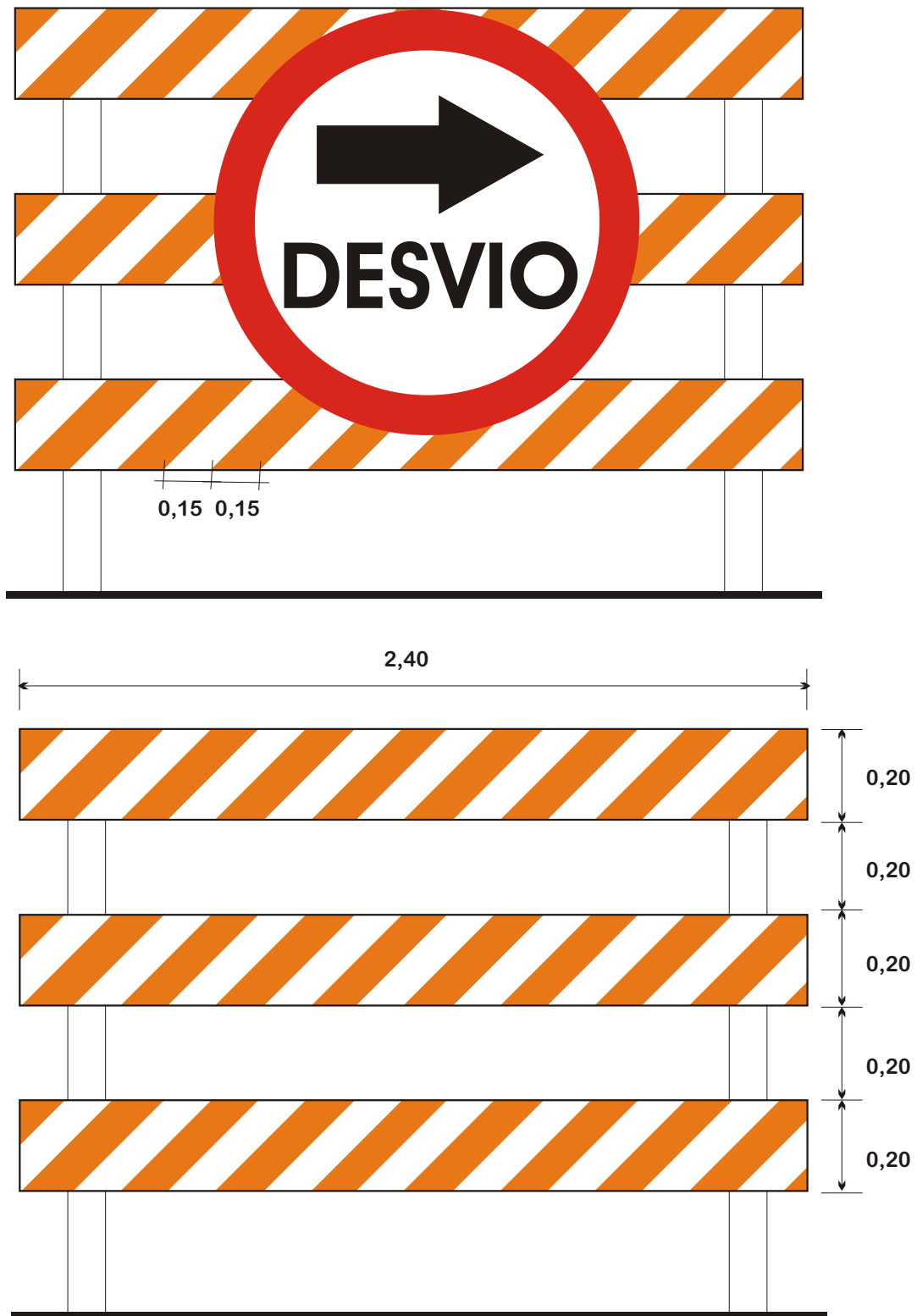
Figura 4.1 Barricadas (dimensiones en metros)
