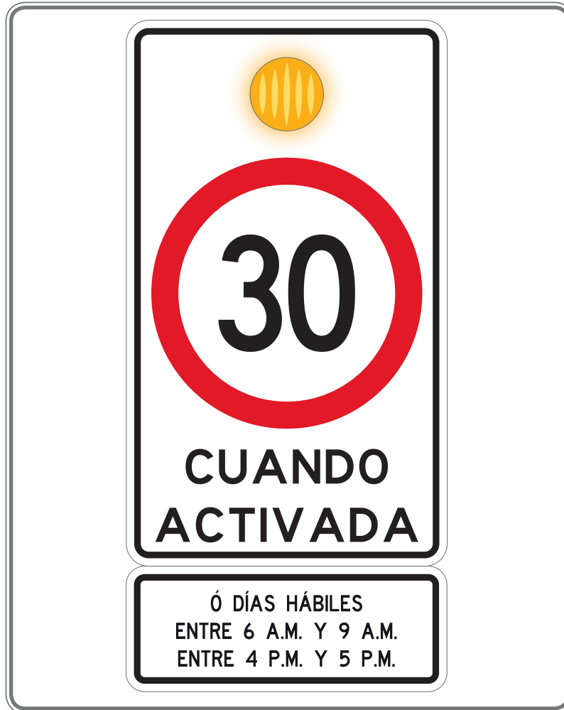
Figura 3-40 Señal con Baliza Destellante
