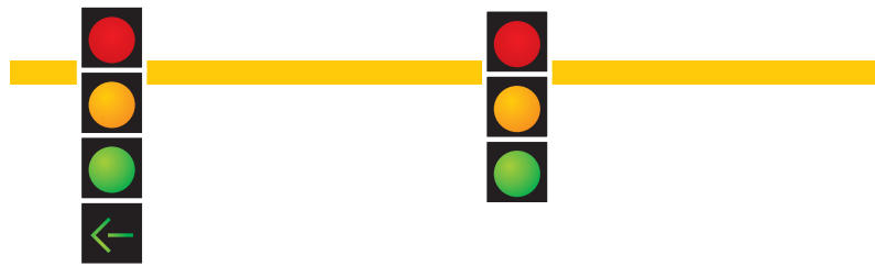
Figura 7-14b Indicaciones de Llegadas con Carril(es) Compartidos de Giro a la Izquierda y Derecha sin Flujo de Paso
