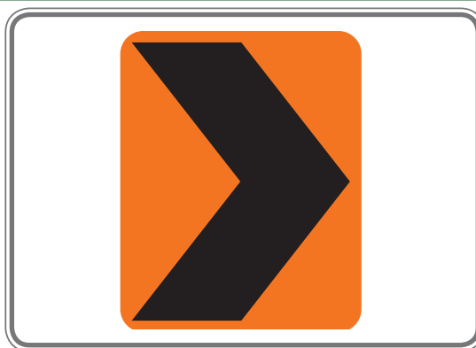
Figura 4-14b Delineador de Curva Horizontal Doble
