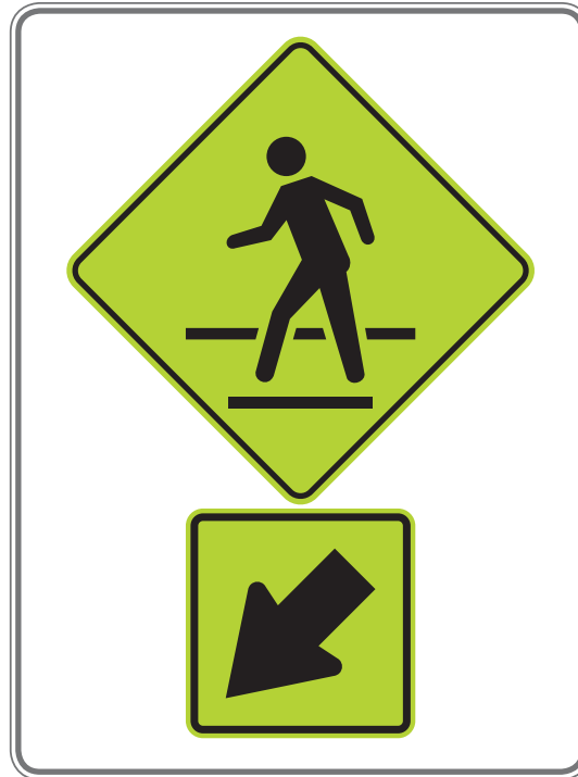
Figura 6.1-5 Señal SP-46B Ubicación Cruce Peatonal
