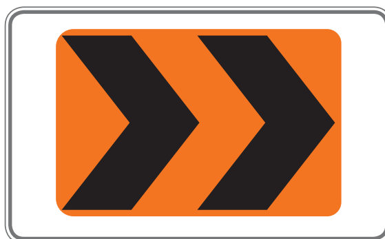
Figura 4-14b Delineador de Curva Horizontal Doble
