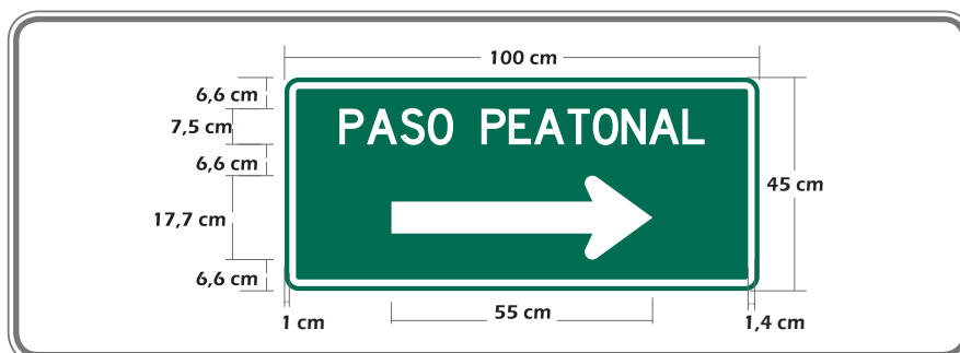
Figura 6.1-6 Señal Informativa para Peatones
