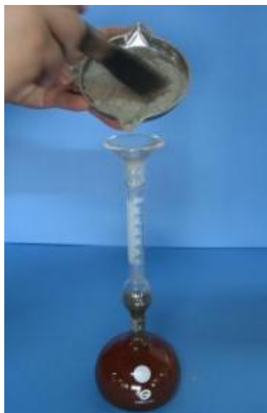
Figura 307 - 3. Adición del cemento
