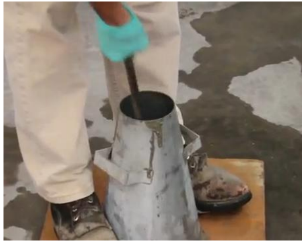
Figura 404 - 3. Apisonado de una capa con la varilla
