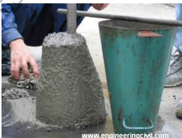
Figura 404 - 6. Medida del asentamiento (Fuente: www.engineeringcivil.com )
