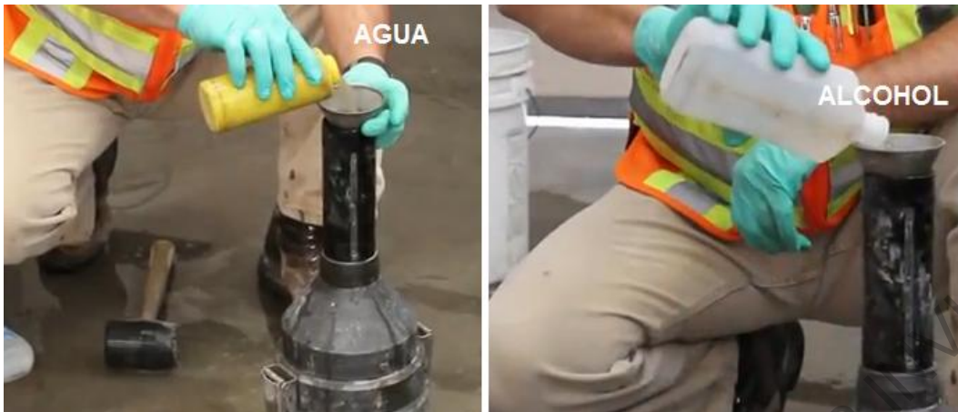
Figura 409 - 5. Adición de agua y alcohol
