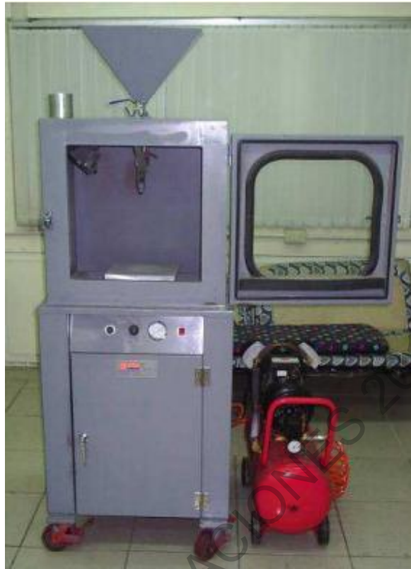
Figura 425 - 2. Gabinete para el ensayo del chorro de arena y compresor
