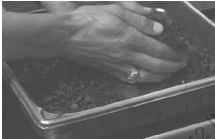
Figura 735 - 5. Separación manual de las partículas de la muestra
