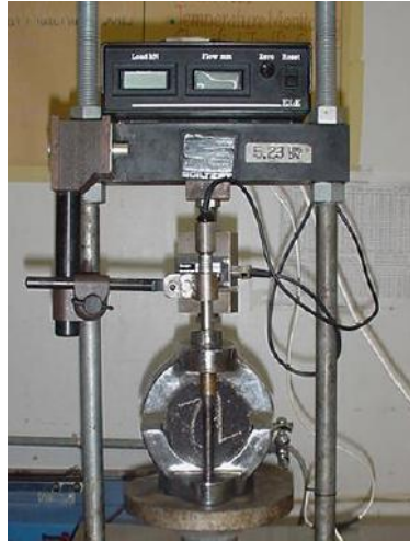
Figura 748 - 12. Aplicación de carga a la probeta Marshall
