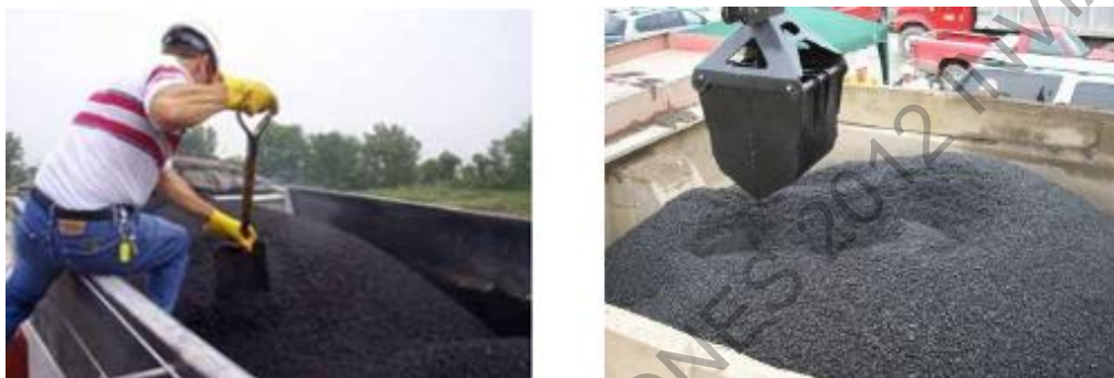
Figura 731 - 2. Muestreo en un vehículo de transporte
