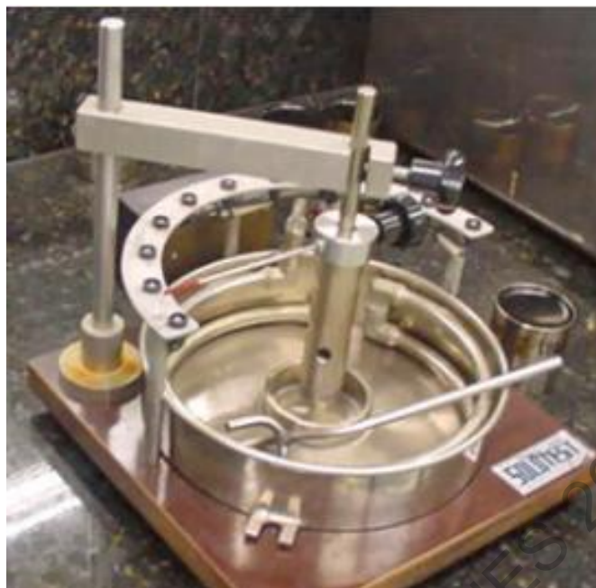
Figura 727 - 1. Elementos para el ensayo de torsión
