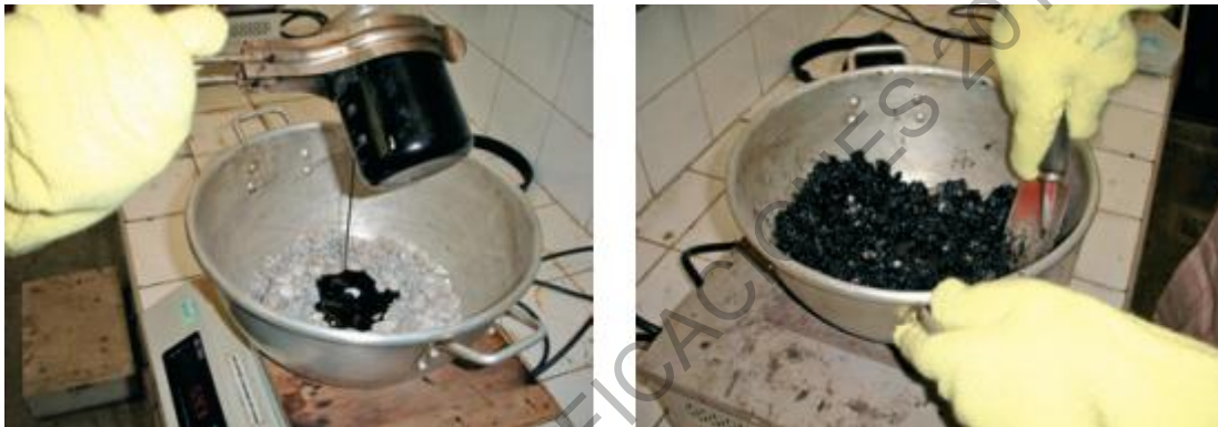
Figura 748 - 9. Adición del asfalto a los agregados y mezcla manual sobre una placa calefactora
