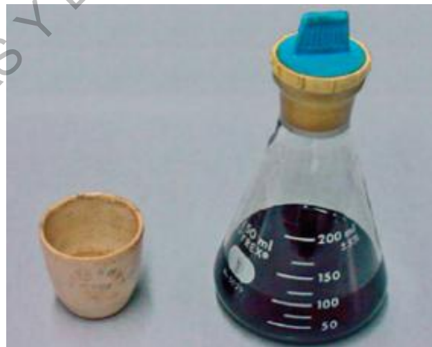
Figura 713 - 3. Muestra disuelta en tricloroetileno
