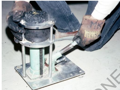
Figura 748 - 11. Extracción de la probeta
