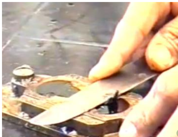
Figura 702 - 2. Enrase de la probeta
