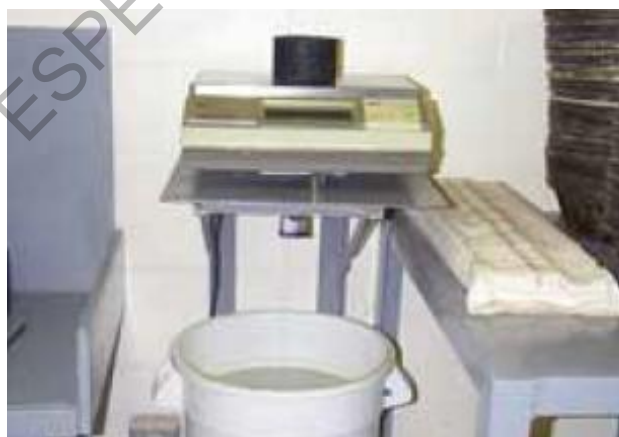
Figura 733 - 3. Determinación de la masa del espécimen en el aire
