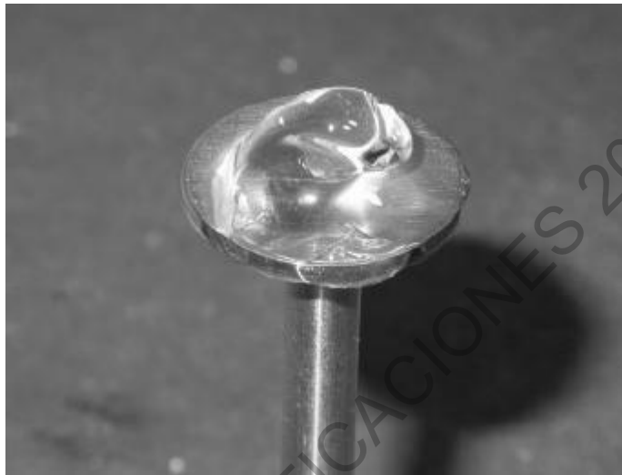
Figura 750C - 3. Método del toque directo para colocar el fluido de referencia en el plato
