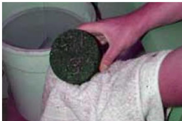
Figura 733 - 2. Secado superficial del espécimen
