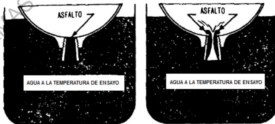
Figura 711 - 4. Irrupción del agua dentro del flotador
