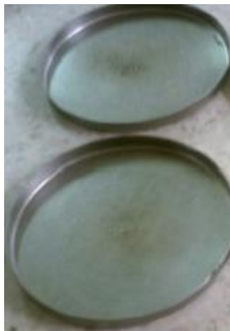
Figura 721 - 2. Recipientes para el ensayo al horno de lámina asfáltica delgada
