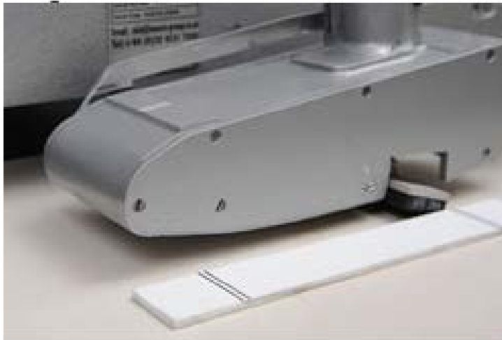
Figura 792 - 7. Medidor de la longitud de contacto
