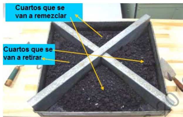
Figura 776 - 7. División de la muestra en cuatro partes
