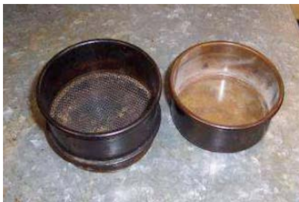
Figura 765 - 1. Tamiz de 850 \mu\text{m} y fondo
