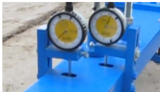
Figura 795 - 7. Lecturas finales de los dials en una viga doble
