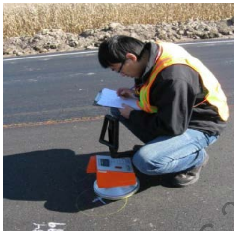
Figura 787 - 1. Ejemplo de equipo electrónico de contacto superficial para medir la densidad de un pavimento asfáltico en el sitio
