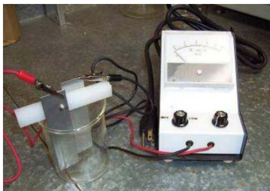
Figura 767 - 1. Equipo para determinar la carga de partículas
