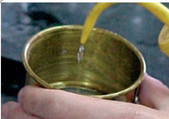
Figura 765 - 2. Humedecimiento de la malla del tamiz
