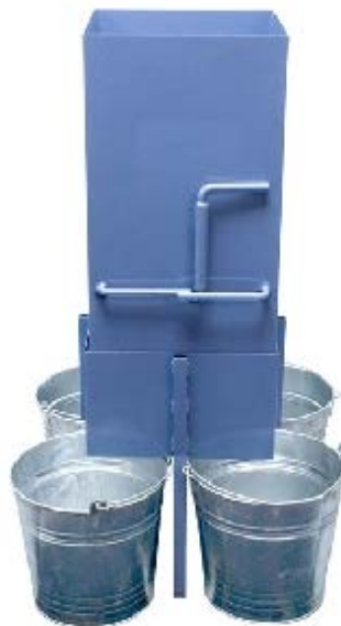
Figura 776 - 3. Cuarteador tipo A y recipientes para recibir las descargas
