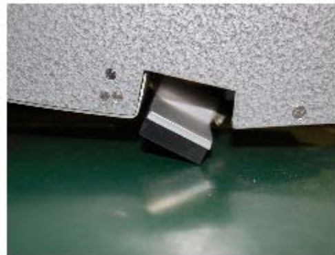
Figura 792 - 4. Detalle del montaje de la zapata de caucho
