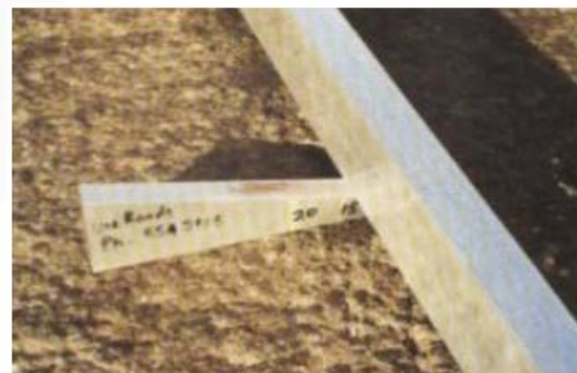
Figura 789 - 2. Cuña graduada como elemento para medir la profundidad del ahuellamiento
