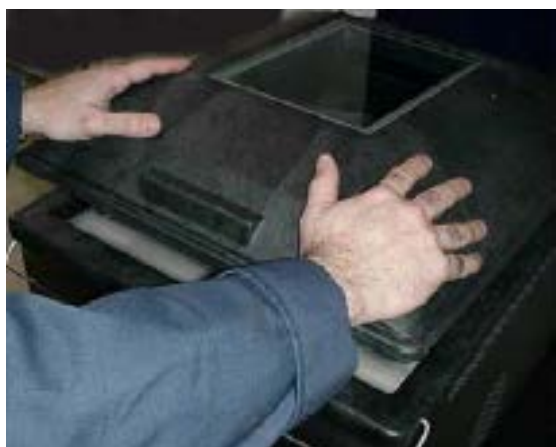
Figura 802 - 3. Cierre de la puerta de la cámara
