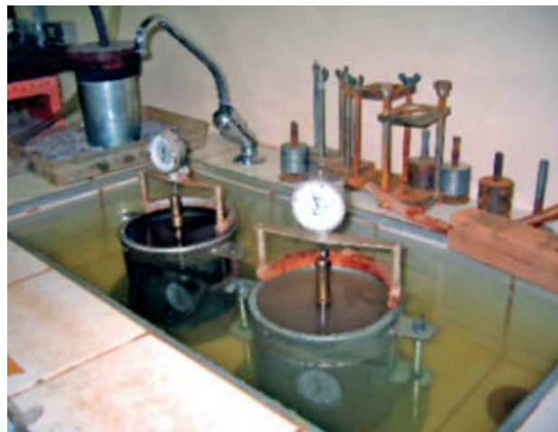
Figura 148 - 2. Medida de expansión axial
