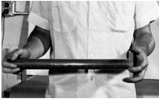
Figura 133 - 8. Método manual de agitación
