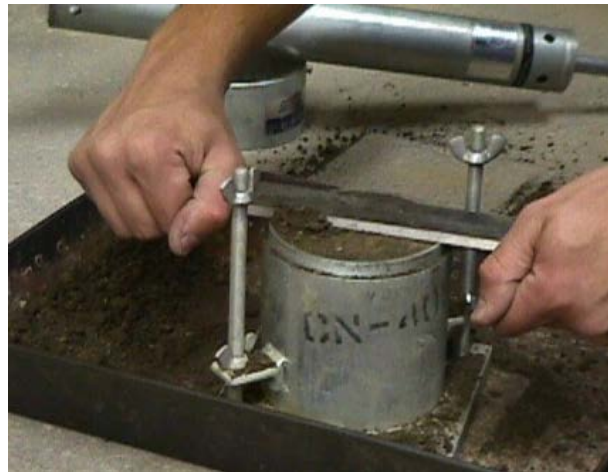
Figura 141 - 5. Enrase de la probeta
