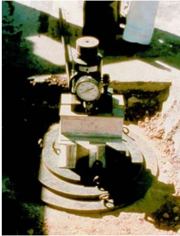
Figura 168 - 1. Placas de carga y gato para el ensayo de placa directa
