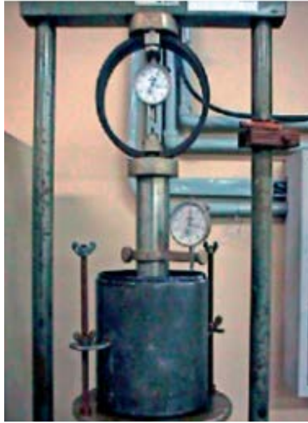
Figura 148 - 3. Ensayo de penetración
