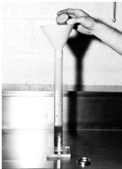
Figura 133 - 6. Transferencia del espécimen al cilindro graduado
