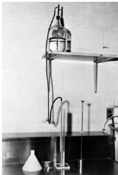
Figura 133 - 5. Cilindro graduado, tubo irrigador, dispositivos para tomar lecturas y sifón
