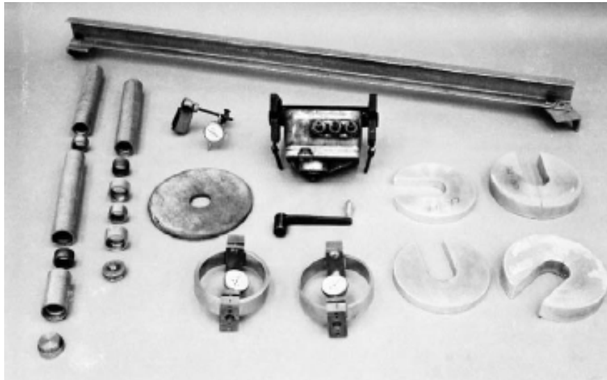
Figura 169 - 2. Elementos para el ensayo CBR in-situ
