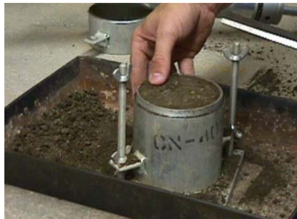
Figura 141 - 6. Relleno de pequeños vacíos superficiales
