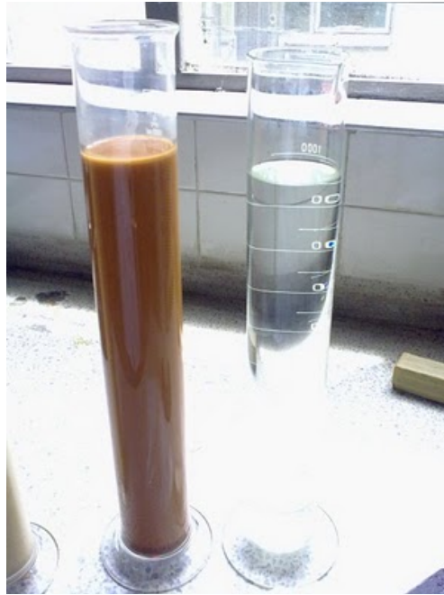
Figura 123 - 5. Cilindros para sedimentación
