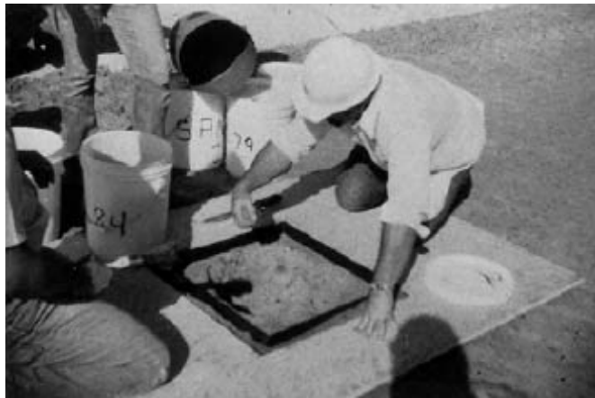
Figura 165 - 5. Excavación del pozo de ensayo
