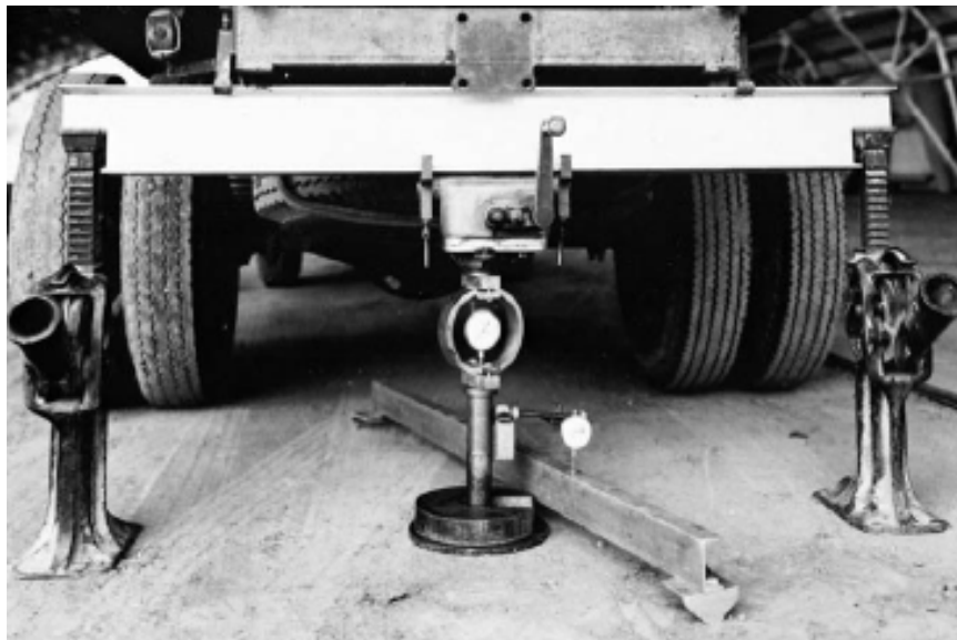
Figura 169 - 1. Montaje para el ensayo CBR in-situ
