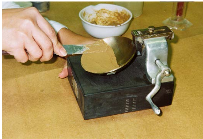
Figura 125 - 6. Colocación del suelo dentro de la cazuela
