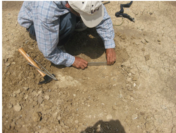
Figura 161 - 2. Preparación de la superficie de ensayo
